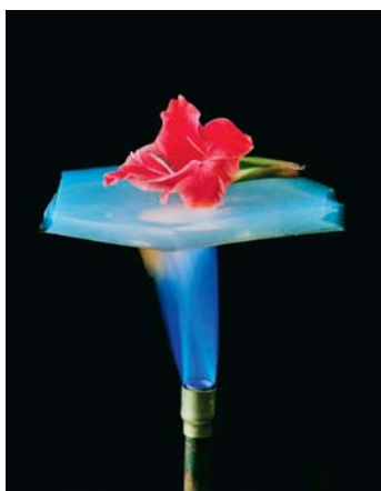
SLIKA 1 – Zaštitna cvijeta od Bunsenova plamena \text{SiO}_2 aerogelom 2
