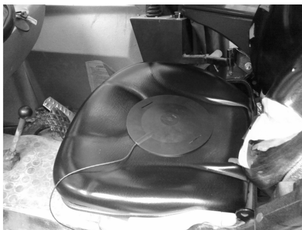
Fig. 2 Measuring of vibrations on the seat Slika 2. Mjerenje vibracija na sjedištu
