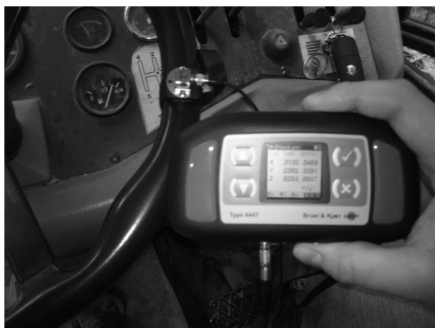
Fig. 1 Measuring of vibrations on the steering wheel Slika 1. Mjerenje vibracija na kolu upravljača
