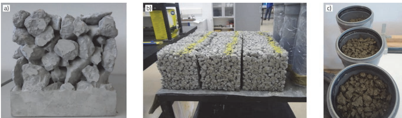
Slika 1. Izrada uzoraka: a) vibrirani uzorak betonske kocke; b) nevibrirani uzorci betonskih prizmi; c) uzorci za ispitivanje protočnosti
