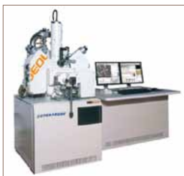
51 Jedan od EPMA analizatora tvrtke Jeol One of the Jeol Company's EPMA analyzers
