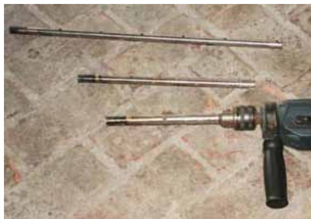
56 Svrđla razne duljine za minimalnu invaziju i destrukciju drva za uzorkovanje s pomoću bušilice (preuzeto iz: Published by English Heritage (2004.): Dendrochronology, Guidelines on producing and interpreting dendrochronological dates, 22, English Heritage.).
