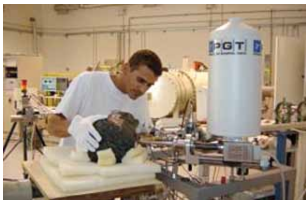
36 PIXE in air analiziranje legure na spoju glave Apoksiomena u Institutu „Ruđer Bošković“ (preuzeto iz prezentacije M. Jakšića, nav. dj.) PIXE in air analysis of the alloy at the connection of Apoxyomen's head at the Ruđer Bošković Institute (taken from a presentation M. Jaksic, op. cit.)
