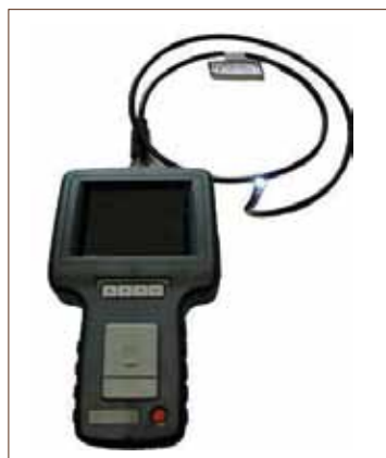
24 Digitalni fleksibilni boroskop s kamerom.
