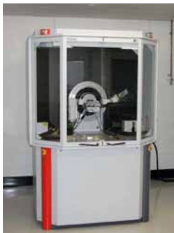
40 Jedan od modela XRD analizatora (difraktometara) One of the models of the XRD analyzers (defraktometers)
