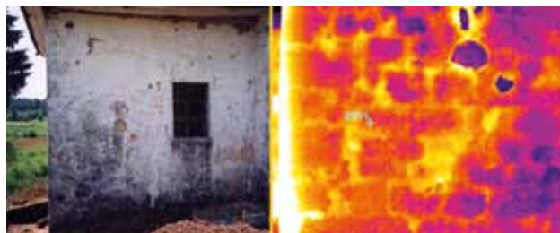
27 Fotografija zida crkve sv. Jurja u Mateškom Selu. Termografija otkriva i strukturu zida ispod žbuke. (preuzeto iz: B. Srša, nav. dj.) Photo of the wall of the church of St Juraj in Mateško Selo. Thermography also revealed the structure of the wall under the plaster. (taken from: B. Srša, op. cit.)
