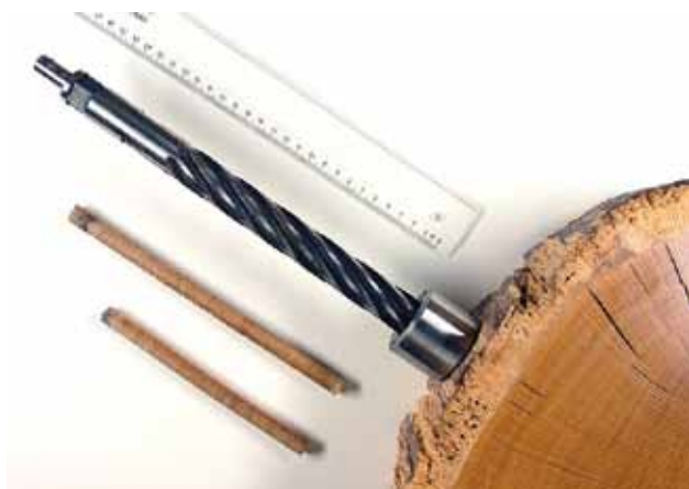
55 Svrđlo za minimalnu invaziju i destrukciju drva uzorkovanjem za dendrokronologiju
