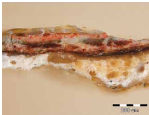
6 Mikrofotografija poprečnoga presjeka uzorka lab. broj 11969, reflektirano svjetlo (foto: M. Klofutar) Micro-photograph of the diagonal cross-section of laboratory sample no. 11969, reflected light (photo: M. Klofutar)
