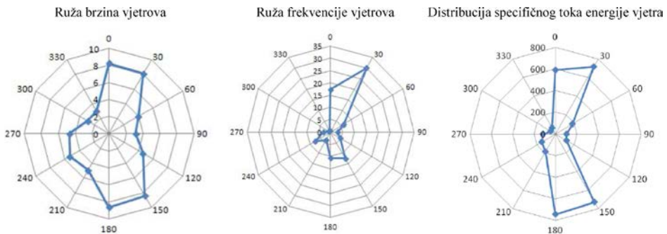
Slika 3. Ruža brzina vjetrova, ruža frekvencije vjetrova i distribucija specifičnog toka energije vjetra po sektorima (slijeva nadesno) na visini mjerenja od 50 m.
