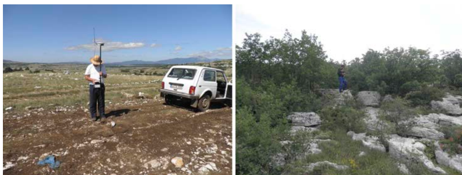
Slika 14. Detalj snimanja poprečnih profila duž trase pristupnih i opskrbnih cesta.
