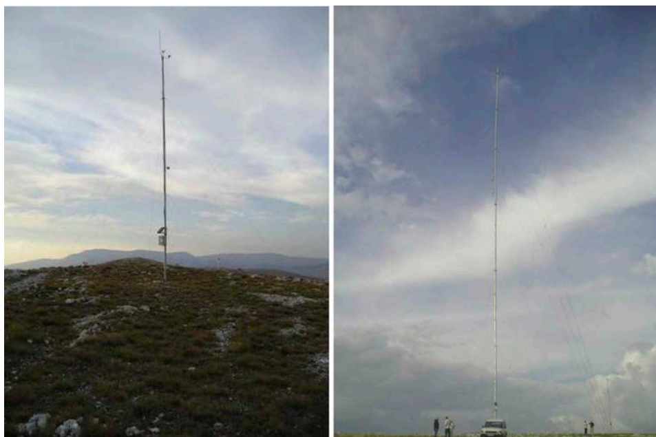
Slika 1. Mjerni stupovi visine 10 m i 50 m na lokaciji VE Mesihovina.
