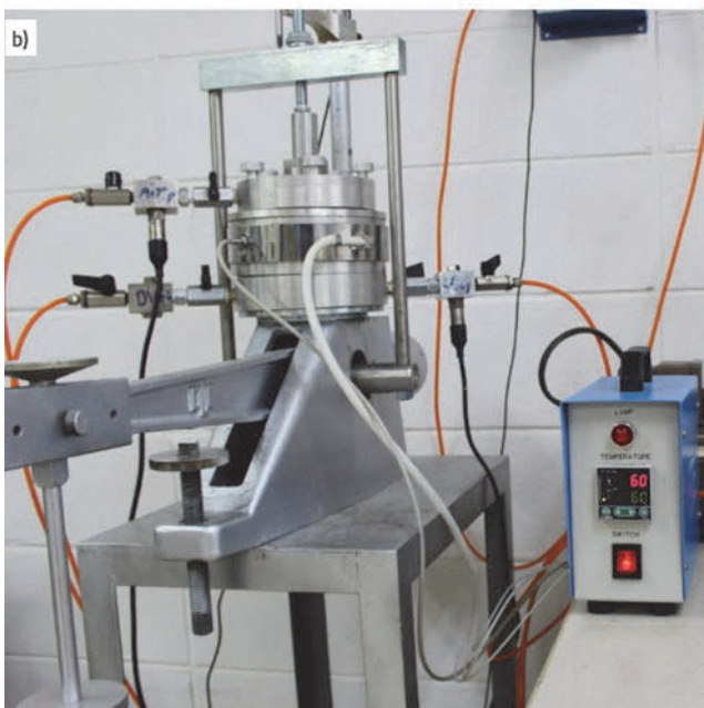
Slika 2. Modificirani edometar: a) shematski dijagram; b) fotografija edometra
