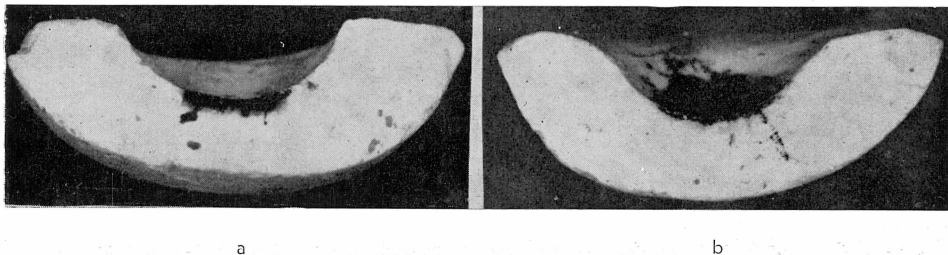
Sl. 6. Blokovi fosfatnog cementa »R a c i m« i njegova propusnost mastila. — a) Propusnost cementa meko namešane konzistencije. — b) Propusnost cementa srednje tvrde konzistencije.
