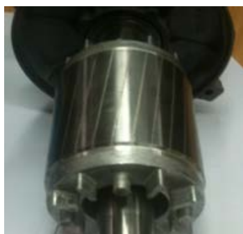
Slika 3. Fotografija rotorskog paketa i kaveza s perima za balans
