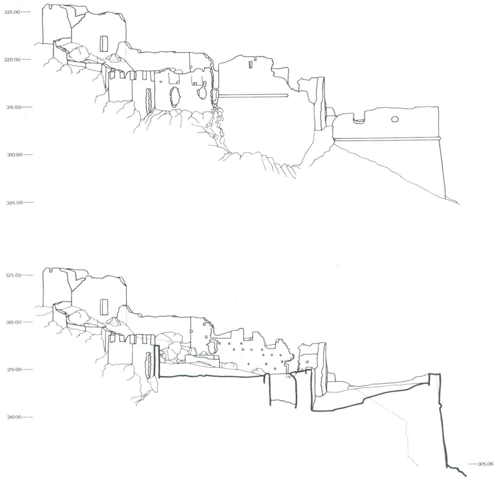
Tvrđava Starigrad, istočno pročelje i presjek a'—e'
