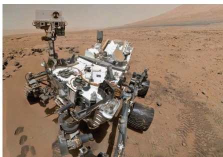
Slika 9 – Curiosity, marsovski rover: primijenjena je rendgenska kristalografija u analizi uzoraka tla na planetu Mars u listopadu 2012. NASA je u rover ugradila difraktometar. Rezultat analize pokazao je da su uzorci Marsova tla slični tlima nastalima trošenjem bazaltnih stijena havajskih vulkana (NASA).
