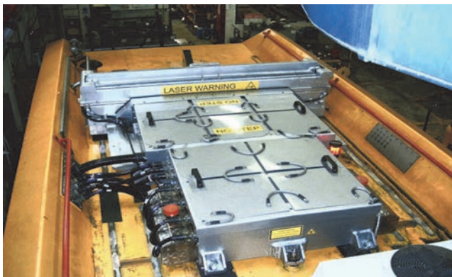
Slika 18. Sustav za mjerenje parametara stanja kontaktne mreže
