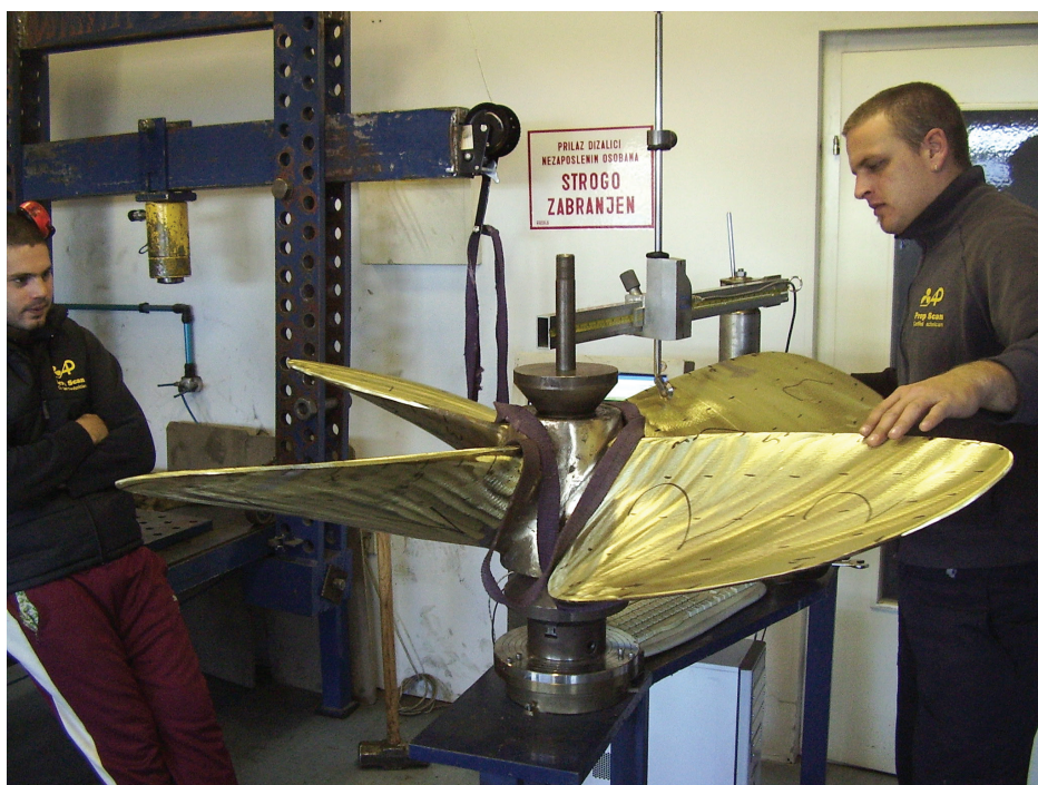
Slika 8. Postupak mjerenja vijka ELICHE RADICE B6 Prop Scan tehnologijom [1, 13]
