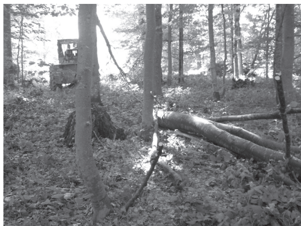
Slika 4. Sakupljanje dijelova stabla manjih od 3 cm promjera s korom vitlom skidera LKT 81
