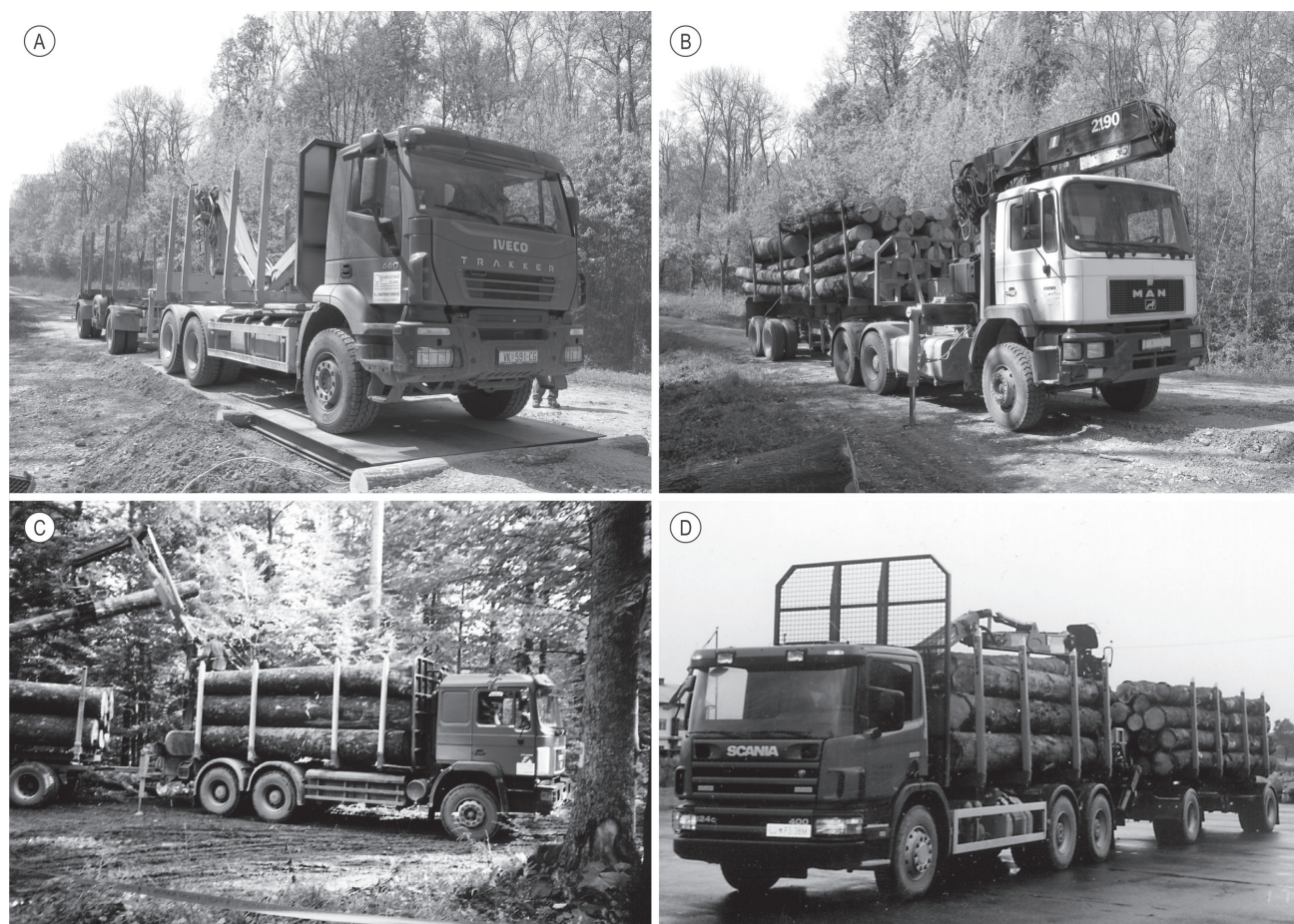
Slika 1. Kamionski skupovi »Hrvatskih šuma« d.o.o. A) IVECO Trakker, B) MAN 33-422, C) MAN 33-464, D) SCANIA P124
