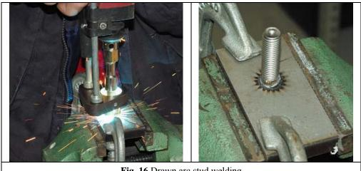
Fig. 16 Drawn arc stud welding
