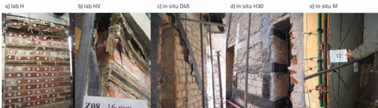
Slika 19. Načini loma FRP ojačanih zidova tijekom provedenih ispitivanja
