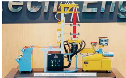
SLIKA 22 – Laboratorijska oprema tvrtke Labtech Engineering za ekstrudiranje crijevnog filma (Foto: Labtech Engineering )
