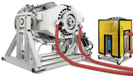
SLIKA 35 – Hlađenje cijevi novim sustavom IPA (Foto: KraussMaffei Berstorff)
