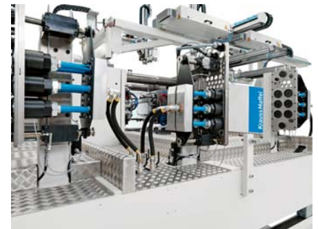
SLIKA 28 – Automatska izmjena kalupa za manje od tri minute (Foto: KraussMaffei )
