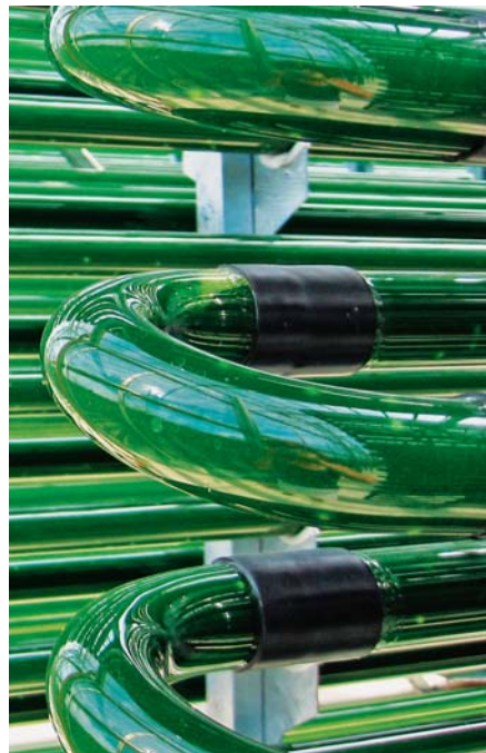
SLIKA 15 – Fotobioreaktor načinjen od novoga prozirnog PVC-a Apex RE 9118A (Foto: Teknor Apex)
