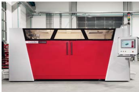
SLIKA 17 – Voxeljet VX2000 za izradu velikih tvorevina 3D tiskanjem (Foto: Voxeljet )
