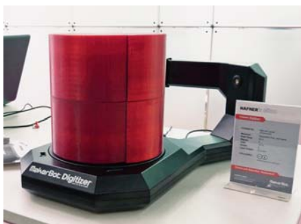
SLIKA 10 – 3D skener MakerBot (Foto: A. Pilipović)
