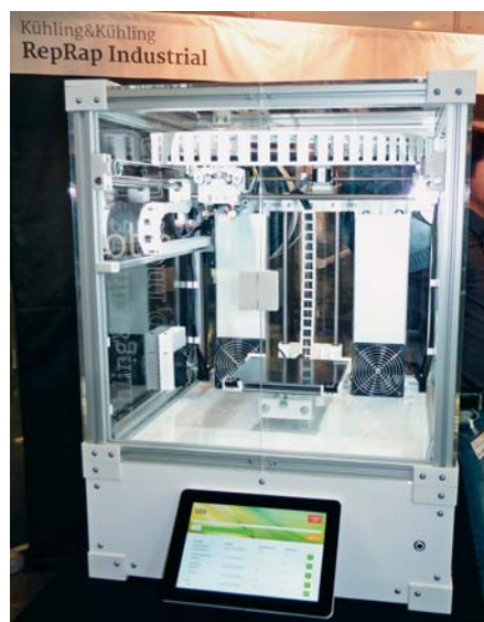
SLIKA 11 – Industrijski pisač The Kühling&Kühling RepRap (Foto: A. Pilipović)
