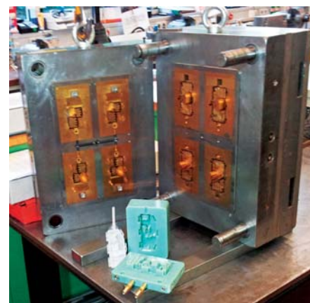
SLIKA 8 – Kalupi načinjeni CNC obradom i postupkom PolyJet uz gotovu tvorevinu (Foto: Stratasys )
