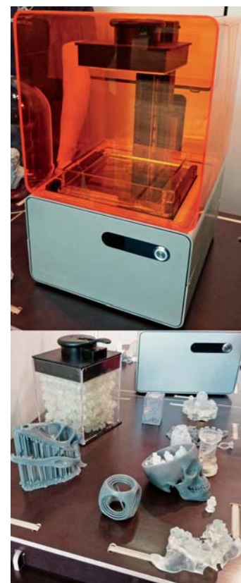
SLIKA 4 – Niskobudžetni uređaj za stereolitografiju Formlab i tvorevine načinjene na Formlabu (Foto: A. Pilipović)
