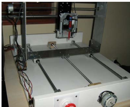
Slika 7. Izgled y osi stroja i pripadnog koračnog motora
