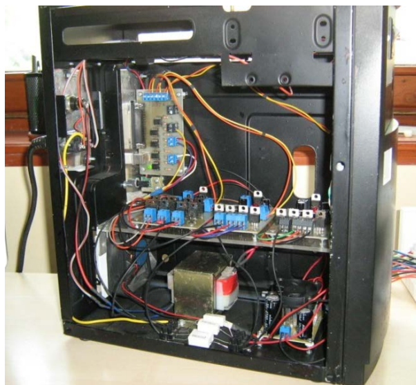
Slika 6. Kućište u kojem su smješteni elektronički sklopovi koji upravljaju CNC strojem
