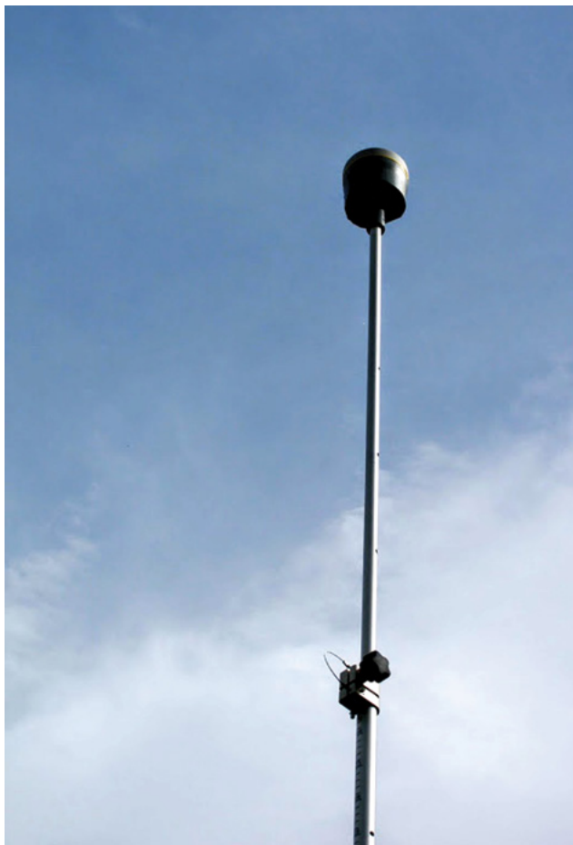
Slika 5.2. Testiranje xFill tehnologije GNSS uređajem Trimble R10
