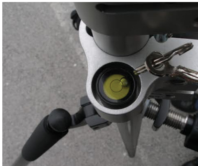
Slika 4.1. Kalibracija elektronske libele uz pomoć mehaničke na štapi i dvoonošca
