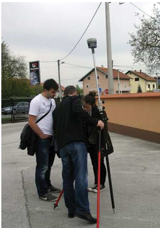
Slika 4.2. RTK izmjera točaka s nagnutim štapom antene GNSS prijemnika
