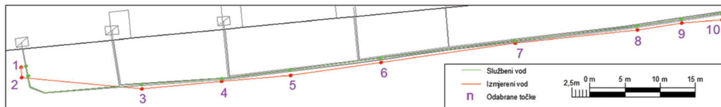
Slika 18. Grafička usporedba mjenenog i službenog voda
