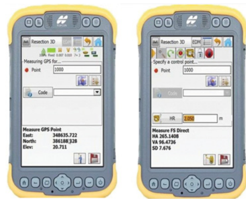
Slika 3.1.2. Sučelje MAGNET Field softvera prilikom izvođenja hibridnog presjeka na Tesla kontroleru pomoću: a) GNSS mjerenja i b) optičkog mjerenja
