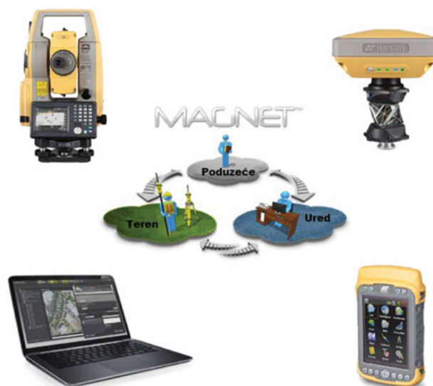
Slika 2.1. Prikaz sastavnica sustava hibridnog pozicioniranja (URL-5)
