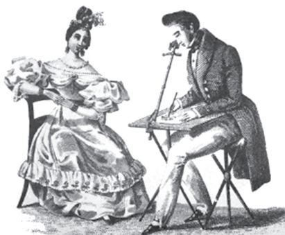
Slika 2. - Ilustracija camere lucide u upotrebi (1807.)
