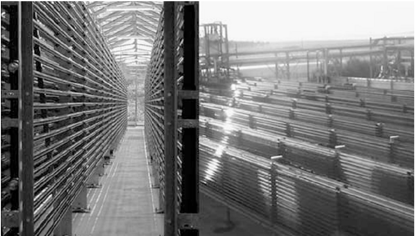
Slika 2. Zatvoreni sustavi za uzgoj mikroalgi u cijevnim fotobioreaktorima (Pulz i sur., 2001) Figure 2. Close microalgae cultivation systems in tubular photobioreactors (Pulz et al., 2001)
