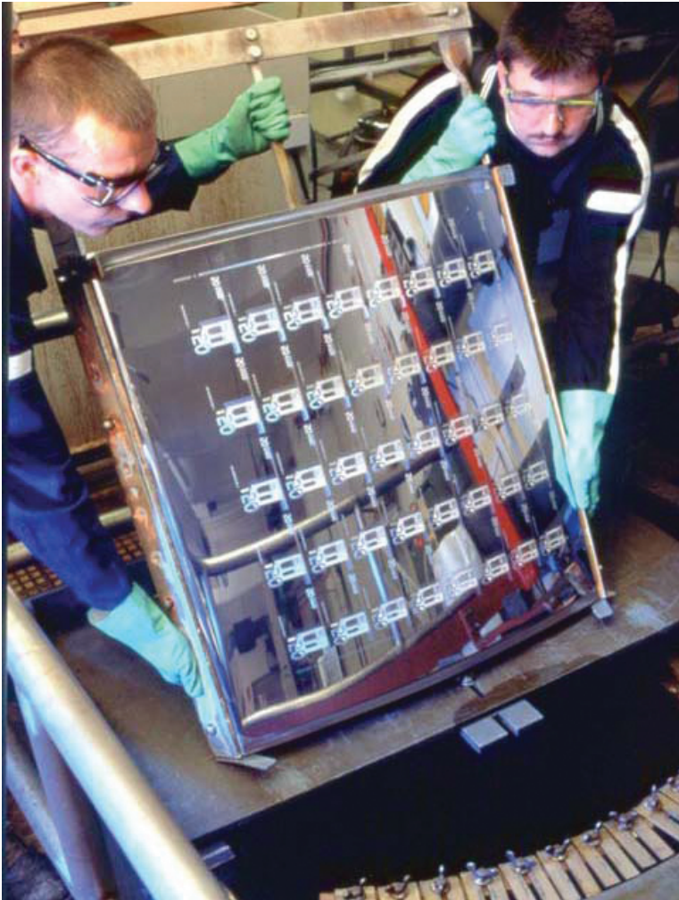
Slika 7: Elektrokemijsko jetkanje proizvodne tiskovne forme za novčanice eura
