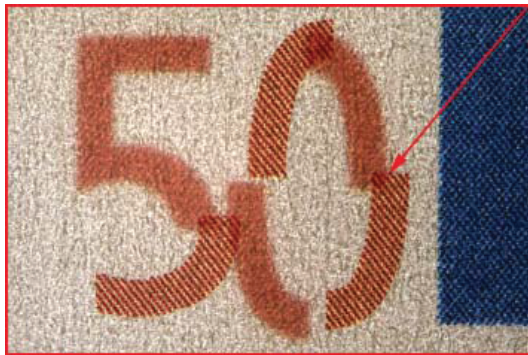
Slika 1: Loše imitiran prozirni registar na krivotvorenoj novčanici od 50 eura (segmenti oznake nominale "50" s lica i naličja ne uklapaju se u propusnom svjetlu)
