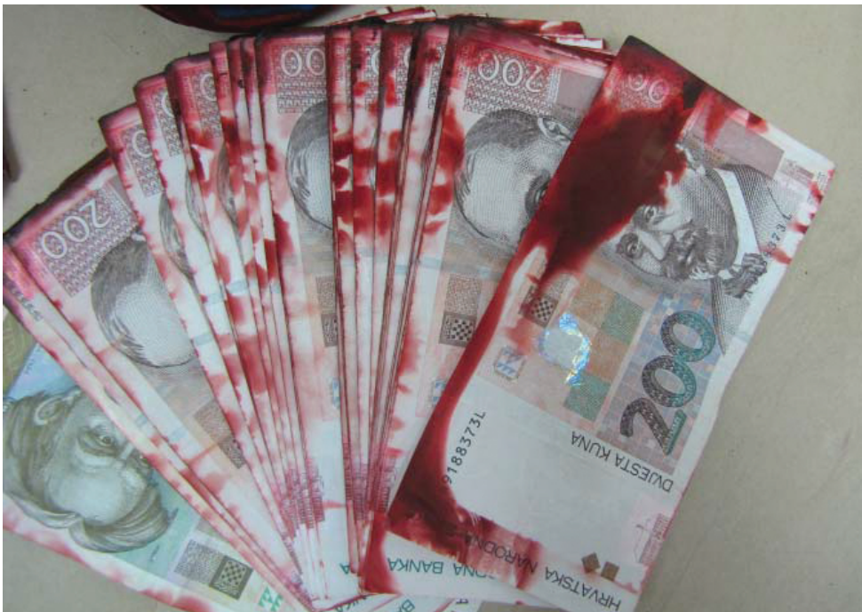
Slika 4: Originalne novčanice hrvatske kune obojene uslijed aktivacije elektrokemijske zaštite unutar sigurnosnog spremnika
