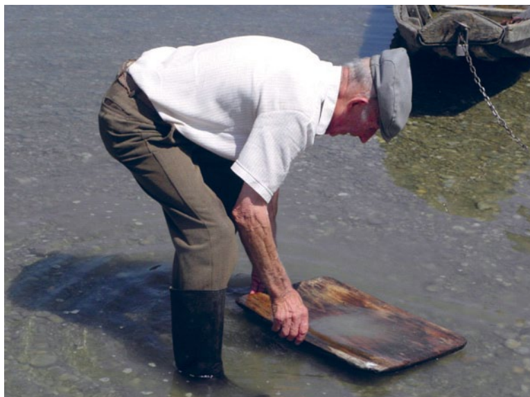
Slika 3. Stari ispirač zlata na Dravi Matej Horvat iz Donjeg Vidovca sakupio je teške minerale sa stola za ispiranje u plitku drvenu tacu u kojoj pročišćava teške minerale od sitnih čestica gline i eventualnih iverja drveta od stola. Taj posao se obavlja u nekoj plitkoj i mirnijoj uvali rijeke
