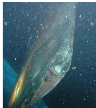
Slika 10. Oštećenja desnog kormila Figure 10. Damage to the right rudder
