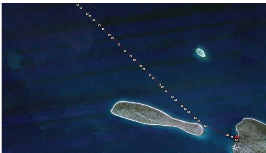
Slika 6. Kretanje broda „Marko Polo“ neposredno prije nasukavanja - pozicije utvrđene obalnim AIS sustavom Figure 6. The proceeding of the vessel „Marco Polo“ before grounding – positions ascertained by means of coastal AIS system
