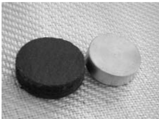
Figure 1. A sample of the examined composite material; left: reinforcement in the form of a carbon profile Slika 1. Uzorak ispitivanog kompozitnog materijala: lijevo - ojačanje u obliku ugljičnog profila
