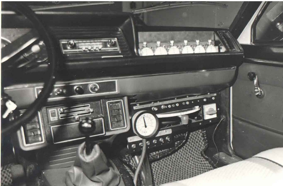
Ispitna stanica u INA RN Sisak - Instrumenti i pomoćni uređaji u kabini ispitnog vozila
