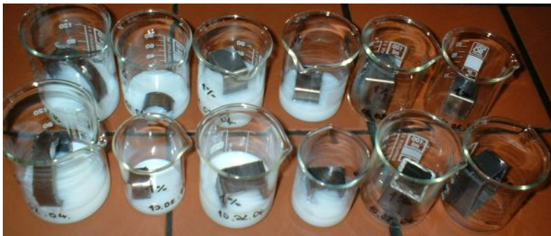
Slika 8: Ispitivanje korozije na dijelovima cijevi u 1 %-tnoj emulziji, uronjeno, i samo premazano emulzijom, bez uranjanja
