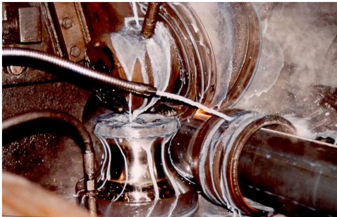
Slika 1: Hlađenje impедера rashladnom emulzijom kod zavarivanja cijevi
