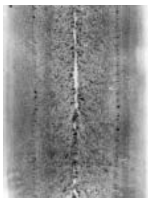
Slika 6. Konti gredica - uzdužni presjek Figure 6. Longitudinal section of continuous cast billet
