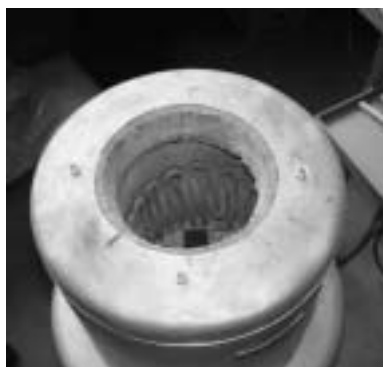
Figure 3. Position of mould in the furnace Slika 3. Smještaj kalupa u peći
