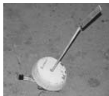
Figure 2. Thermocouple on precursor Slika 2. Termopar na prekursoru
