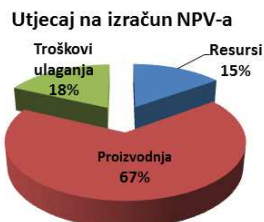
Slika 6. Raspodjela nesigurnosti nasuprot „neto sadašnje vrijednosti“ kod nekonvencionalnih projekata (iz HASKETT & BROWN 2011)
