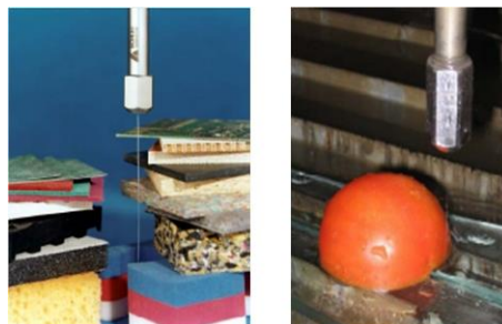
Slika 12. Rezanje anorganskih i organskih materijala vodenim mlazom [7]
