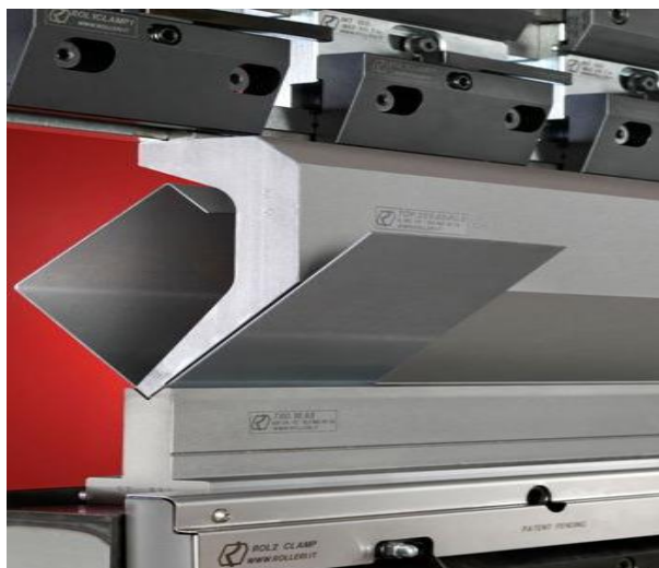
Slika 18. Prikaz savijanja lima na CNC savijačici [10]
