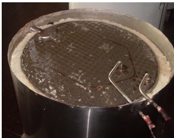
Slika 29. Punjenje kalupa poliuretanskom izolacijom [14]
