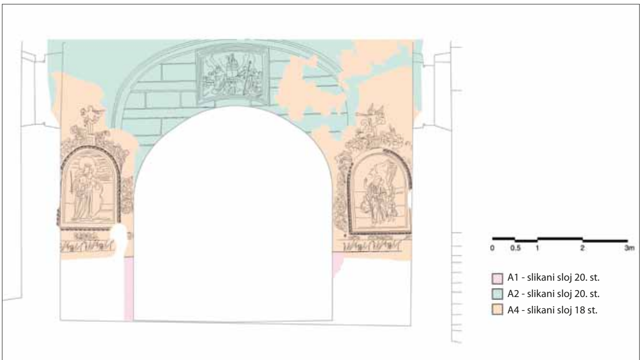
6 Dokumentacija zatečenog stanja slikanih slojeva, zapadni zid trijumfalnog luka (izradili: K. Krulić, M. Kamenar, K. Majer Jurišić, 2013.)
