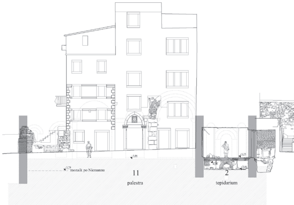
Slika 10. Pretpostavljeno izvorno stanje sjevernog pročelja prema I. Vojnoviću
