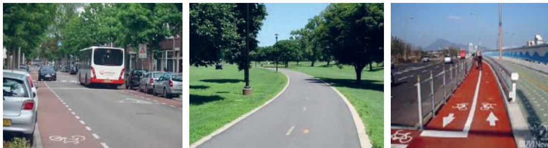
Slika 2. Izgled biciklističke trake na kolniku (a), staze odvojene od kolnika (b) i biciklističke ceste (c)
