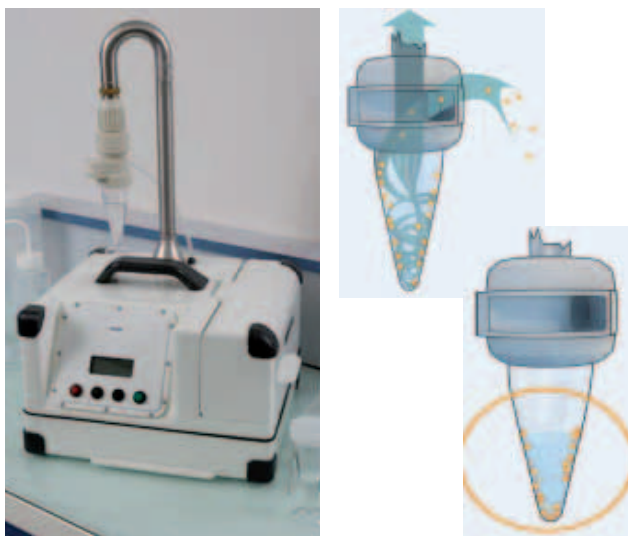
Slika 3.: Ciklonski uzorkivač zraka (Coriolis Delta Air Sampler) kao pumpa turbulentnog strujanja zraka
