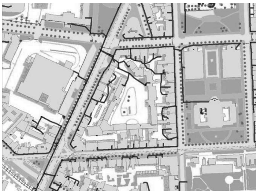
Slika 2. Primjer plana gradnje svjetlovodne distribucijske mreže
