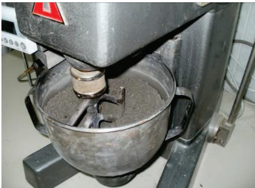
Slika 12. Miješanje betonske smjese
