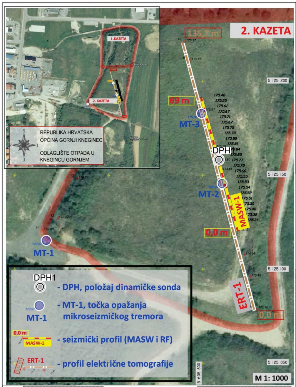
Slika 1. Situacijski plan istraživanja na odlagalištu otpada Knežinec Gornji. Geofizička istraživanja organizirana su položajno u jedinstveni profil, a dinamička sonda DPH-1 nalazi se u središtu geofizičkog profila.
