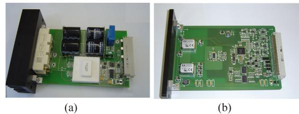
Fig. 3. (a) Power module, (b) DSP module
