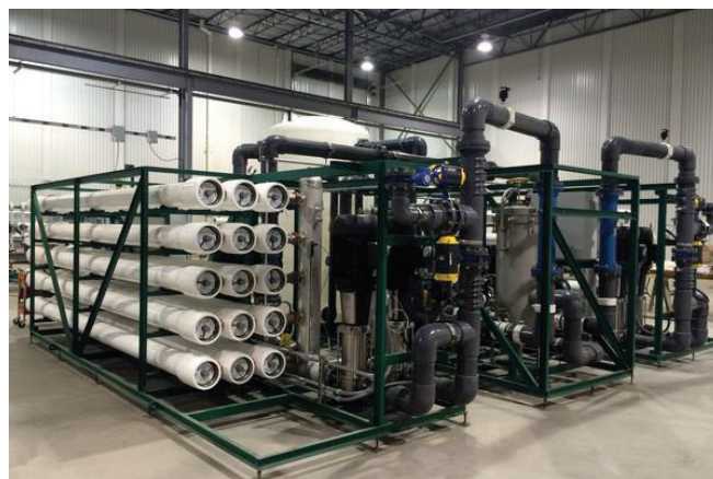
Slika 1 – Reverzna osmoza je postala najučinkovitija tehnologija za desalinizaciju i pročišćavanje vode. Primjer pogona (izvor: Desalitech: http://desalitech.com/ )
