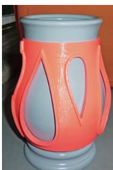
SLIKA 3 – Pramodel nadgrobnog lampiona načinjen postupkom taložnog očvršćivanja
