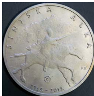
SLIKA 1 – Medalja načinjena selektivnim laserskim srašćivanjem metala
