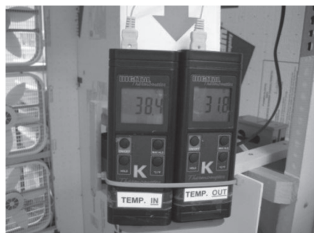
Figure 5. Temperature monitors showing manikin input air temperature and manikin output air temperature values which are needed to compute manikin heat loss values Slika 5. Monitori temperature prikazuju vrijednosti temperature ulaznog i izlaznog zraka kod manekena potrebne za izračun vrijednosti gubitka topline manekena
