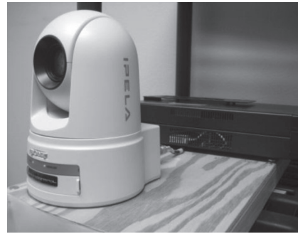
Figure 3. Remote controlled internet camera allowing un-interrupted visual access to the laboratory Slika 3. Internetska kamera na daljinsko upravljanje koja omogućava neprekidan vizualni pristup laboratoriji
