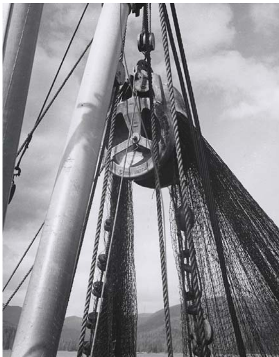
Sl. 7. Izvlačenje mreže pomoću Puretic Power Blocka
