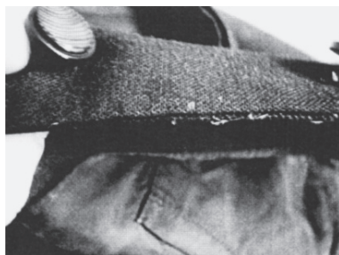
Sl.3 Izvučene niti elastana na rubovima [8]
