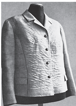
Sl.6 Mjehurići nastali u kemijskom čišćenju na frontalno fiksiranom tekstu uzrokovani nedovoljnom postojanošću ljepljivog sloja između međupodstave i osnovne tkanine [11]
