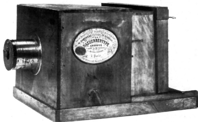
1. Daguerreov aparat za ploče vel. 16,4 x 21,6 cm, proizveden u kolovozu 1839. godine u Parizu
