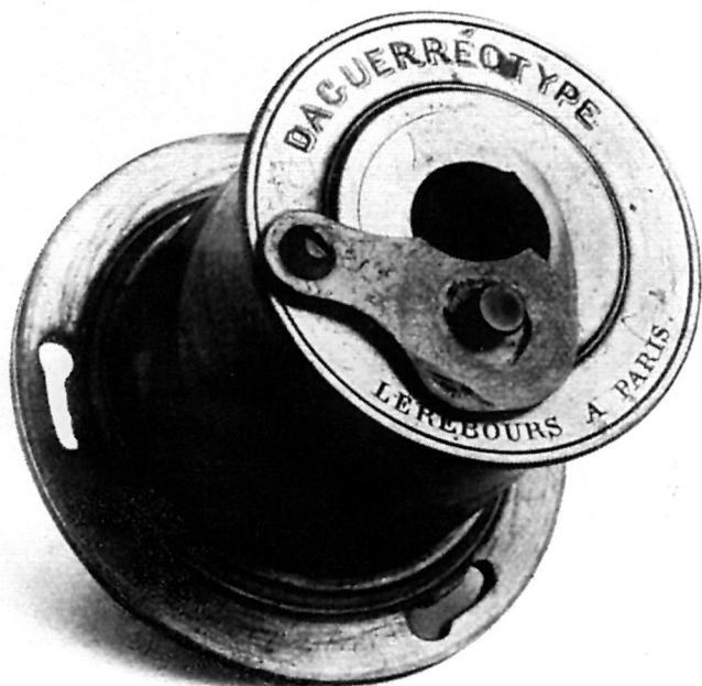
2. Objektiv optičara Lereboursa proizveden za Daguerreov aparat 1839. godine
